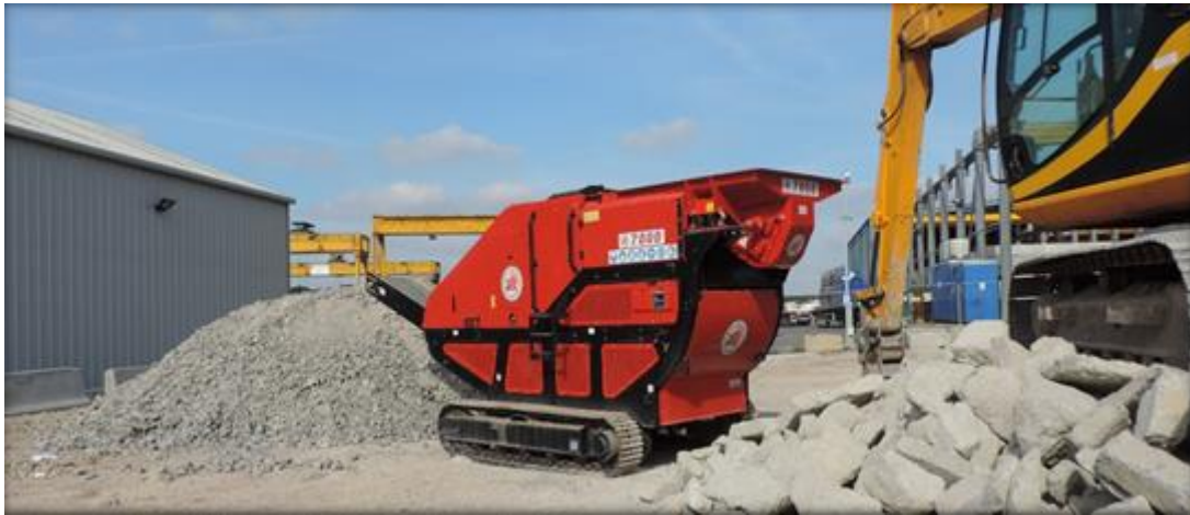
5 TPH mini crusher with dust suppression technology, Red rhino mini crushers, Canada
