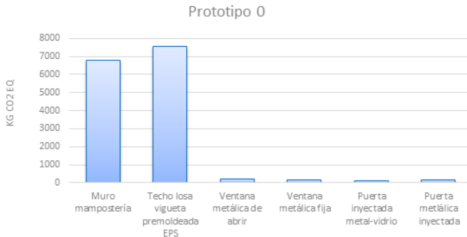
Figura 27: Comparación del impacto potencial sobre el calentamiento global asociado a los componentes utilizados en la construcción del Prototipo 0
