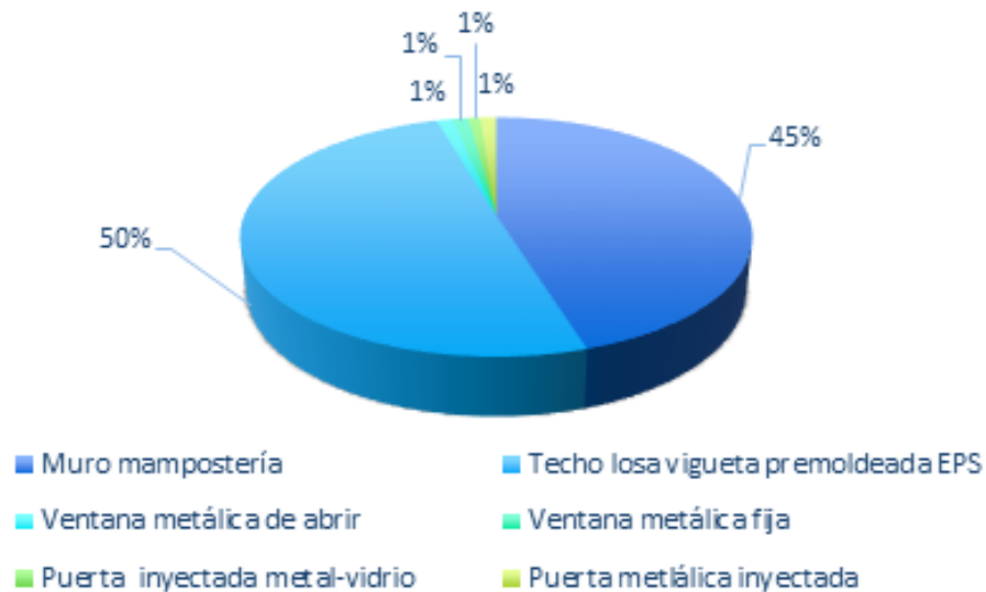
Figura 26: Comparación porcentual del impacto potencial sobre el calentamiento global asociado a los componentes utilizados en la construcción del Prototipo 0
