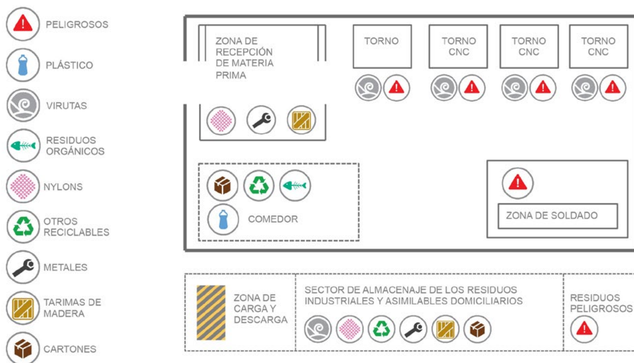
Diagrama 6: ejemplo de puntos de generación y almacenamiento de residuos. (Fuente: ADIMRA)
