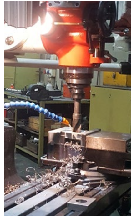
Imagen 4: Mecanizado con fluido de corte (Fuente: ADIMRA)
